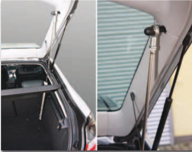
Das Öffnen und Schließen von Flügel- und Schiebetüren sowie der Heckklappe bei Kombifahrzeugen erfolgt elektro-pneumatisch per Knopfdruck oder Fernbedienung. Dies erleichtert jedem das Erreichen des Rollstuhls beim Be- und Entladen.
