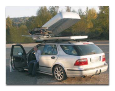
Da der Rollstuhl mit dem Roof Spider von beiden Fahrzeugseiten aus ein- und ausgeladen werden kann, spielt es jetzt keine Rolle mehr, ob Sie als Rollstuhlfahrer das Fahrzeug selbst fahren oder sich als Passagier entspannen wollen. Mit der Handsteuerung wählen Sie, auf welcher Seite der Rollstuhl stehen soll.
