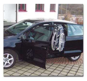
Die Schwenktür mit Rollstuhllift bietet den kompletten Bedienkomfort für mehr Mobilität und Selbständigkeit. Der gefaltete Rollstuhl wird mit den Griffen in den Rollstuhllift eingehängt und per Knopfdruck automatisch im Fahrzeug untergebracht.
