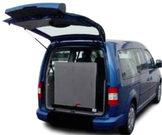
Der tieferliegende Boden wird hochwertig ausgekleidet und kann leicht gereinigt werden. Die Aluminium-Auffahrrampe ist mit einer Gasdruckfeder versehen, welche das Hochklappen erleichtert. Zusätzlich wird ein Handentriegelungssystem verbaut.
