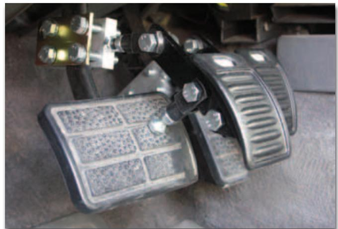
Diese Pedalerhöhung ist zum Auf- und Abklappen mit einem Scharnier versehen. Die Höhenverstellung ist zwischen 30 und 90mm einstellbar.
