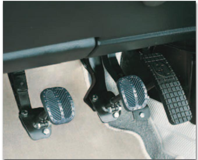
Die Pedalerhöhung erleichtert das Erreichen der Originalpedale. Erhöhungen sind für alle Fußpedale mit Anpassungsmöglichkeit von 35-100mm oder mit festem Maß lieferbar.
