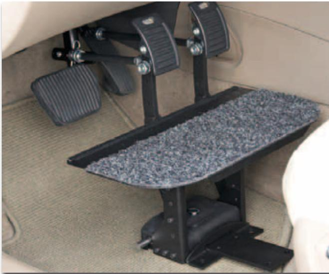
Ist eine Pedalerweiterung von über 100mm notwendig, ermöglicht dies die Pedalerweiterung Stamp. Zur Pedalverlängerung kommt hierbei noch eine Fußablage für entspannteres Fahren hinzu. Der Stamp wird fest montiert, ist aber mit wenigen Handgriffen leicht abnehmbar. Er ist einsetzbar in Schalt- und Automatikfahrzeugen.
