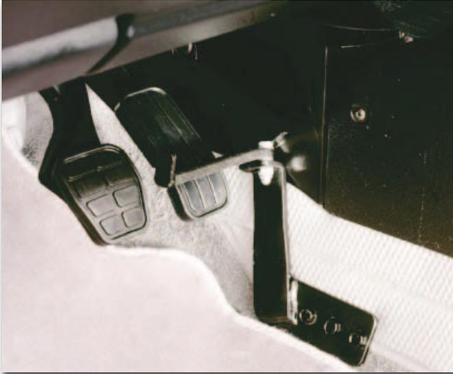
Dieses Gerät verhindert die unbeabsichtigte Betätigung des noch vorhandenen rechten Original-Gaspedals und ist meist zwingend vom TÜV / von der DEKRA vorgeschrieben. Auch die Sperre kann je nach Fußgas links-Modell entweder weggeklappt oder einfach demontiert werden.
