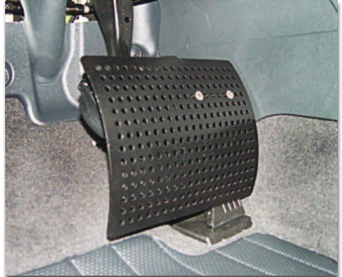
Diese Pedalabdeckung ist erhältlich für das Gaspedal oder für Gas- und Bremspedal. Die Pedalabdeckung ist jederzeit abnehmbar, damit die serienmäßige Bedienung nicht beeinträchtigt wird. Die Pedalabdeckung wird bei allen handbetätigten Gas-Bremsgeräten empfohlen.
