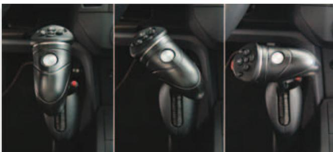
Ist der Multifunktionsdrehknopf 1 oder 2 auf dem Multimaz adaptiert, haben Sie dort durch einfaches Betätigen der Steckachse mehrere, fest positionierte Griffmöglichkeiten.
